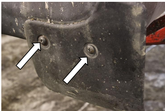
Bilde 6 Festeskrue for skvettlappen
